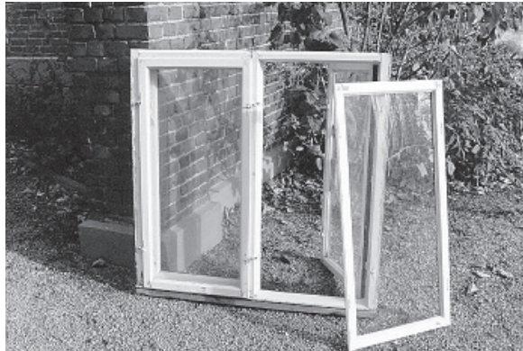
Figur 8.5 Överlufterna sågades av för att anpassa karmens ytermått till provningsutrustningen.
