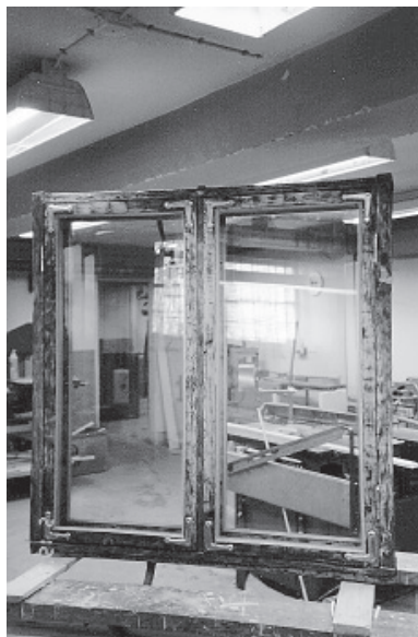
Figur 8.11 Rostskyddsbehandling av hörnjärn utföres genom förtening.
